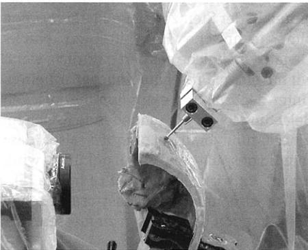
**Abb. 2.** Robotergestütztes Fräsen am Schädelpräparat. Der Fräsvorgang wird mit einer Thermokamera von der Schädelinnenseite beobachtet (siehe Text)
